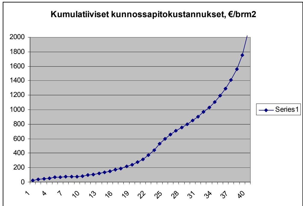
Kuva 11. Kunnossapitokustannusten kumulatiivinen kertymä riippuu rakennuksen ominaisuuksista ja ympäristön asettamista rasitustekijöistä. (Lähde: VTT)
