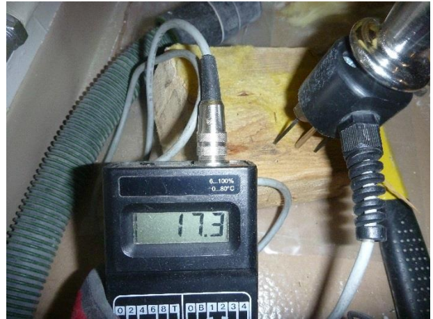
Kuva 27. RA4, Alaohjauspuun alapinnan kosteus 17,3 p% (raja-arvo 15 p%).
