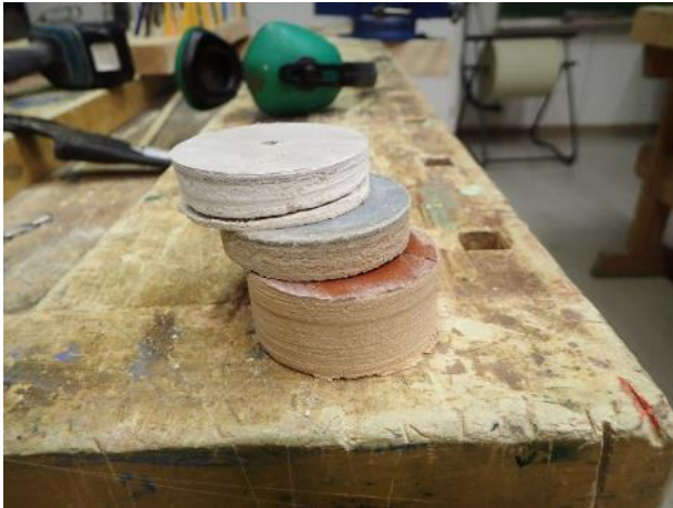
Kuva 17. RA5. Lattian pintakerrokset.
